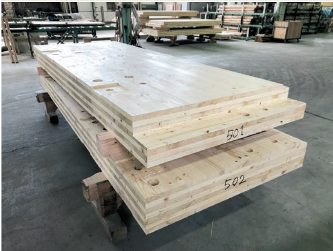
加工後のトドマツCLT 7層7プライ
